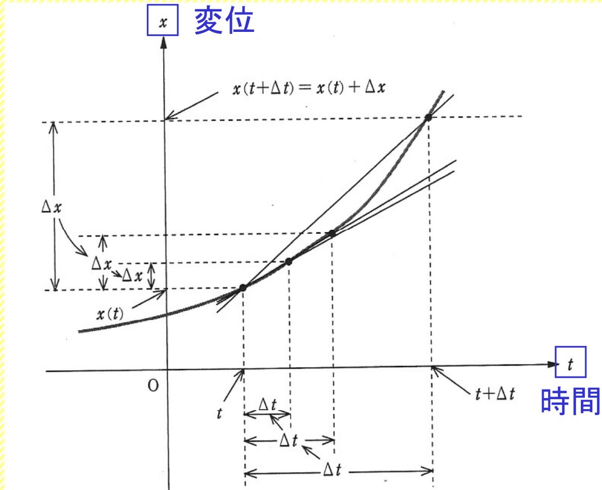
図 1.11 位置-時刻図 ( $x-t$  図) と速度。直線の勾配  $\Delta x/\Delta t$  は時間  $\Delta t$  での平均速度を表す。これらの直線の  $\Delta t \rightarrow 0$  での極限の直線は、時刻  $t$  での  $x-t$  曲線の接線に一致する。この接線の勾配が時刻  $t$  での速度 (瞬間速度) である。
