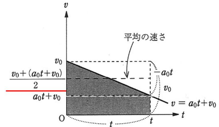
図 1.20 等加速度直線運動。アミの部分の面積  $v_0 t + \frac{1}{2} a_0 t^2$  が移動距離  $s$  である。
