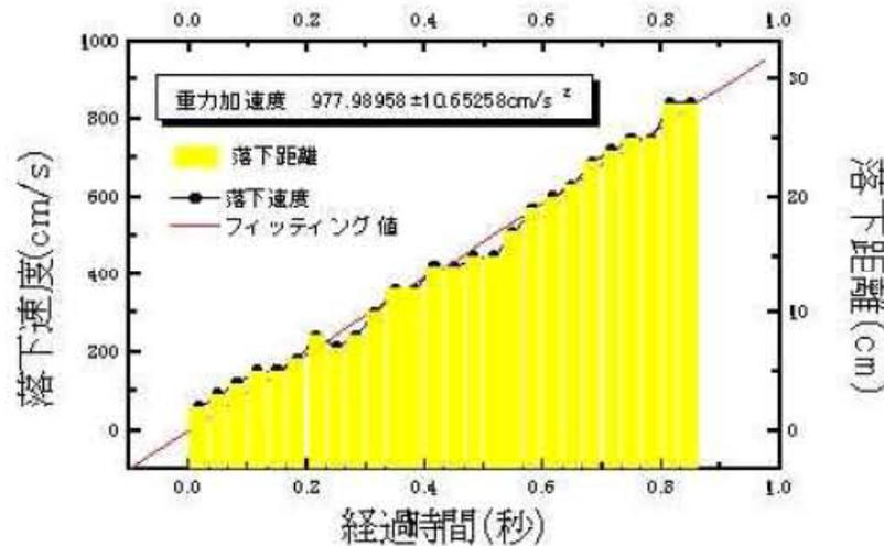
さて、このことから、**重力(g)によって速度(v)は時間(t)に比例して増えていく( $v=gt$ )**、そして、その増える割合は一秒間に **$9.78\text{m/s}$** の速度だけ増え、それを重力加速度と
