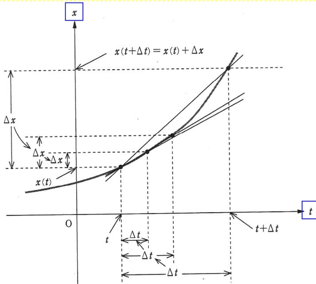
図 1.11 位置-時刻図 ( $x-t$  図) と速度。直線の勾配  $\Delta x/\Delta t$  は時間  $\Delta t$  での平均速度を表す。これらの直線の  $\Delta t \rightarrow 0$  での極限の直線は、時刻  $t$  での  $x-t$  曲線の接線に一致する。この接線の勾配が時刻  $t$  での速度 (瞬間速度) である。
